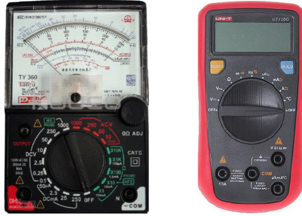
Şekil 1.1: a) Analog avometre, b) Dijital avometre.
